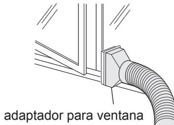
3. Quite el adaptador para ventana. Retire y extraiga el adaptador para ventana presionando en las dos marcas "PUSH" (presionar), y deslice y cierre la cubierta de escape del panel de la ventana (opcional).
